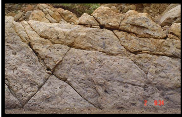
Figura 59.- Fotografía que muestra una serie de diaclasas. Rumbo de la foto S45E
